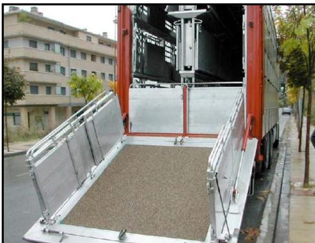
**Fotografía 5.7:** Rampa de carga ascensor y angulable usada en trailer para transporte de cerdos vivos.
