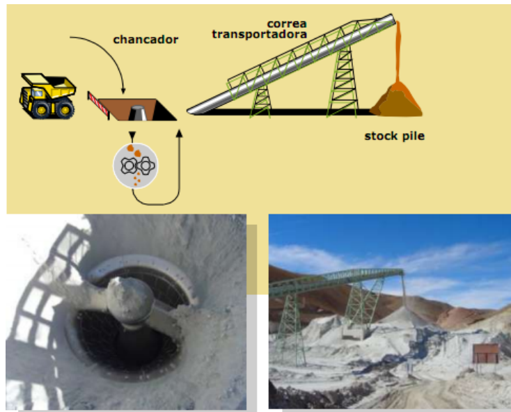
Figura N° 4.6: Layout – Chancado Primario. 34
