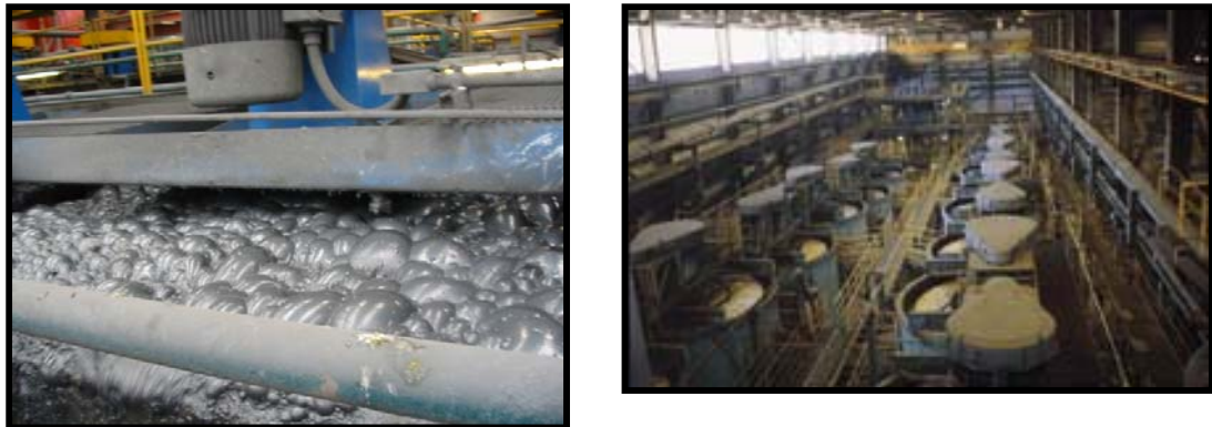
Figura Nº 4.9: Celdas de Flotación Columna, Tercera Limpieza – 2000 feet 3 . 24
