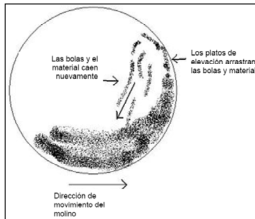
Figura Nº 4.20: Angulo de cascada molienda SAG. 48
