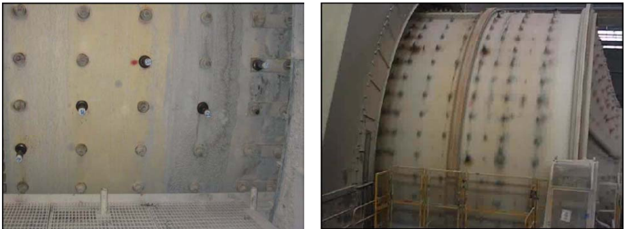
Figura N° 2.14: Instalación Sistema - Sensor Electrónico de Desgaste SED. 16
