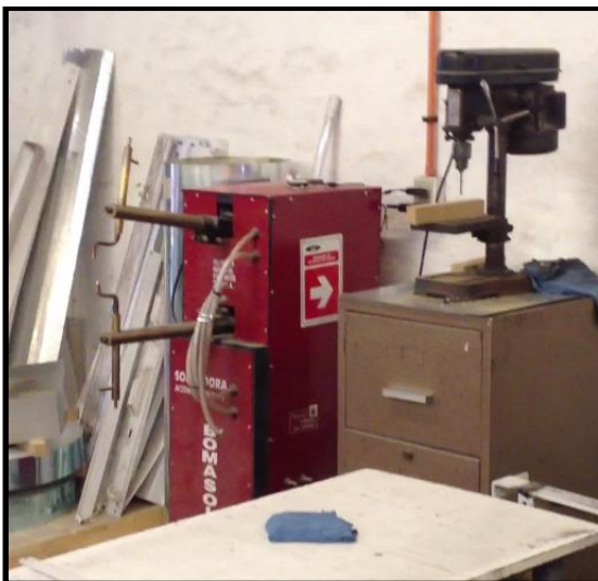
Foto 16. Maquina soldadora de piezas de acero.
