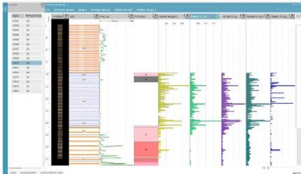
Figura 3-8: Reporte dinámico de sondaje, con histogramas de leyes integrado con información de geología y foto de testigo
