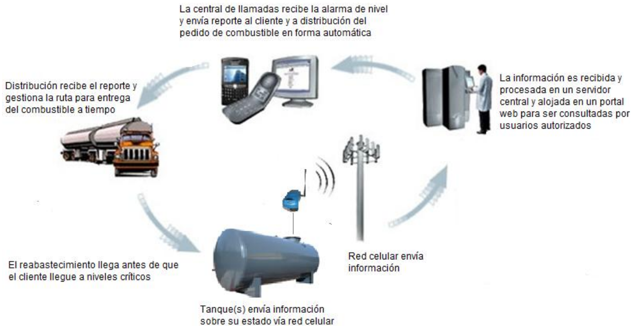
Figura N° 10: Sistema de monitoreo remoto de nivel de tanque de combustible
